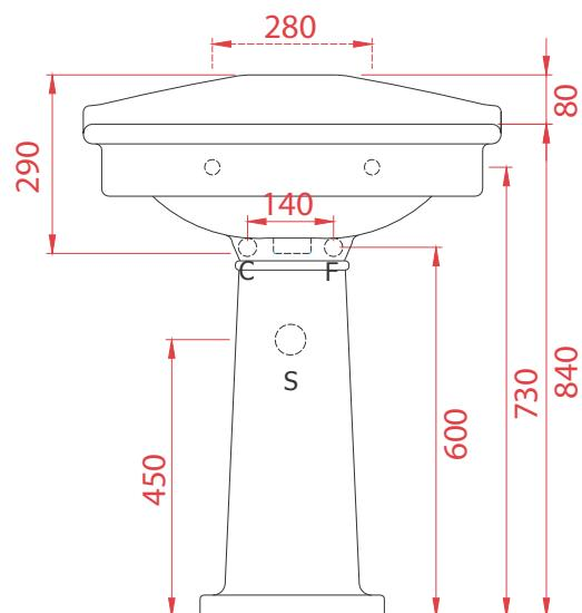
N.B. Le misure indicate possono subire una variazione dell 0,6% circa, dovuta ad usura stampi e a variazioni delle caratteristiche tecniche relative alle materie prime che compongono l'impasto .
