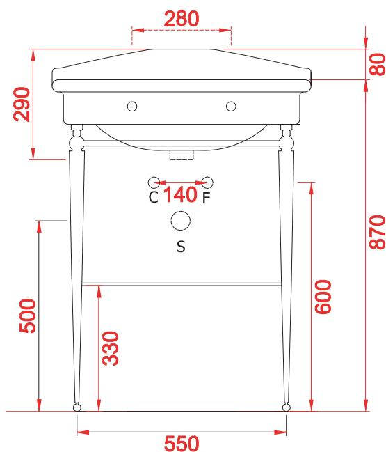
N.B. Le misure indicate possono subire una variazione dell'0,6% circa, dovuta ad usura stampi e a variazioni delle caratteristiche tecniche relative alle materie prime che compongono l'impasto.
