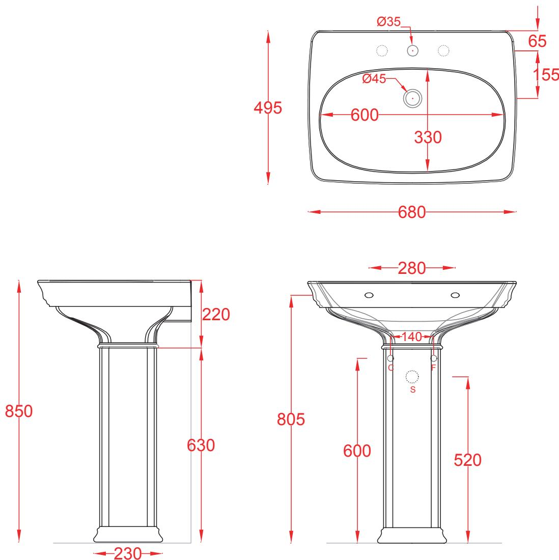
N.B. Le misure indicate possono subire una variazione dell'0,6% circa, dovuta ad usura stampi e variazioni delle caratteristiche tecniche relative alle materie prime che compongono l'impasto.
